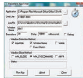
Измерение времени загрузки программы с помощью AppTimer
